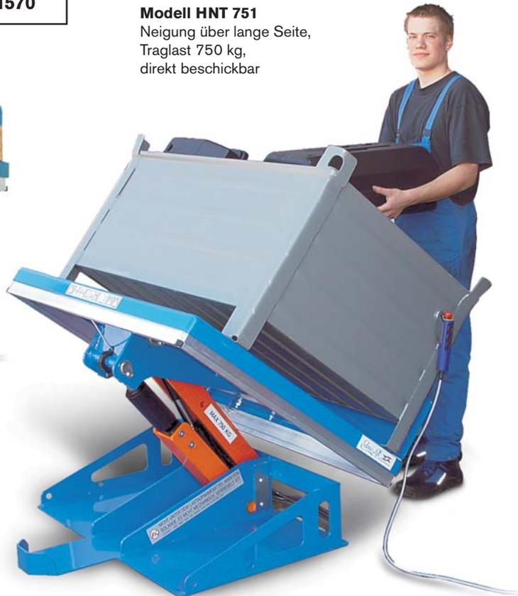
Hub-Neige-Tische besitzen gegenüber den normalen Hubtischen parallele Hubarme, die zum geraden Heben synchron arbeiten, zum Neigen aber einzeln angesteuert werden.
