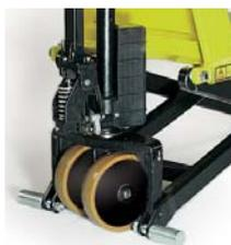
Der Elektro-Scherengabelhubwagen verfügt über einen kräftigen Hubmotor (12 V / 1,6 kW), Batteriekapazität 12 V / 60 Ah. Ein Ladegerät (12 V / 10 A) mit automatischer Abschaltung gehört zum Lieferumfang. Lenkräder mit Vollgummi-Bereifung
