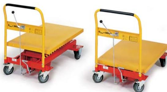
Scheren-Hubtischwagen sind vorgesehen für den innerbetrieblichen Transport schwerer Lasten, die stufenlos auf Arbeitshöhe angehoben oder abgesenkt werden müssen. Die robuste Konstruktion und solide Verarbeitung ermöglichen je nach Ausführung bis zu 500 kg Traglast. Das Hochpumpen erfolgt über einen Fußhebel. Für das Absenken wird das Ventil über ein Gestänge mit einem Handhebel geöffnet.
