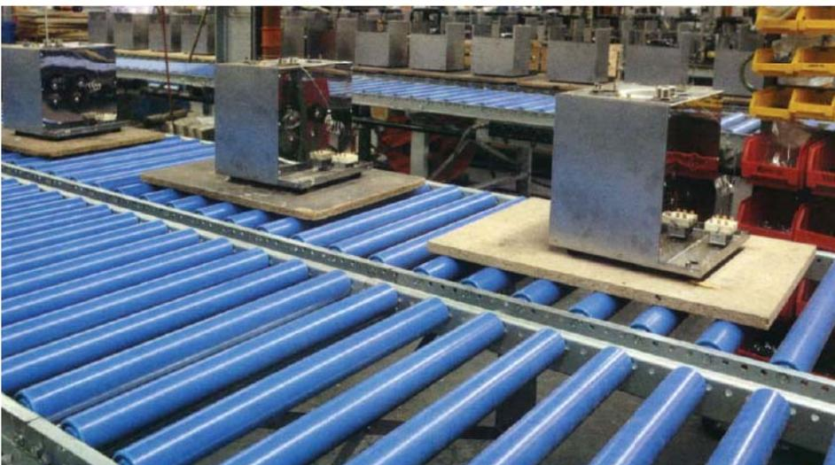
Leichtrollenbahnen dienen zum Transport von Stückgut durch Schwerkraft, d. h. durch leichtes Gefälle. Die erforderliche Neigung beträgt je nach Beschaffenheit und Gewicht des Fördergutes 2-5 %.
