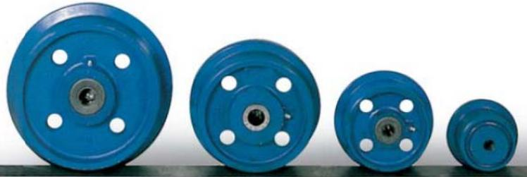
Der Spurkranz und die Lauffläche sind sauber überdreht. Die Lauffläche steigt zum Spurkranz hin um ca. 3° an. Als Rillenkugellager wird eine Ausführung mit Z-Lamellen eingebaut.
