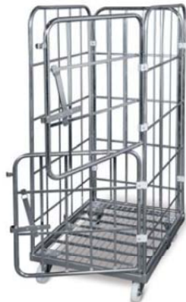
Rollbehälter, 4-seitig mit Gittern Vorderwand wahlweise einteilig, halb abklappbar oder zweiteilig, einzeln schwenkbar, bestückbar mit max. 5 Böden
