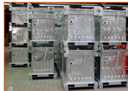
Speciaal-afvalcontainers 145 (voor spuitbussen)
