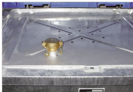
Inloopbak en 2" tankwagenkoppeling
